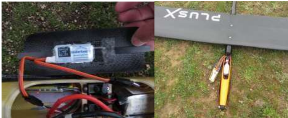
Geklebte Installation in einem Supra und doppelseitige Klebebandinstallation in einem PlusX
