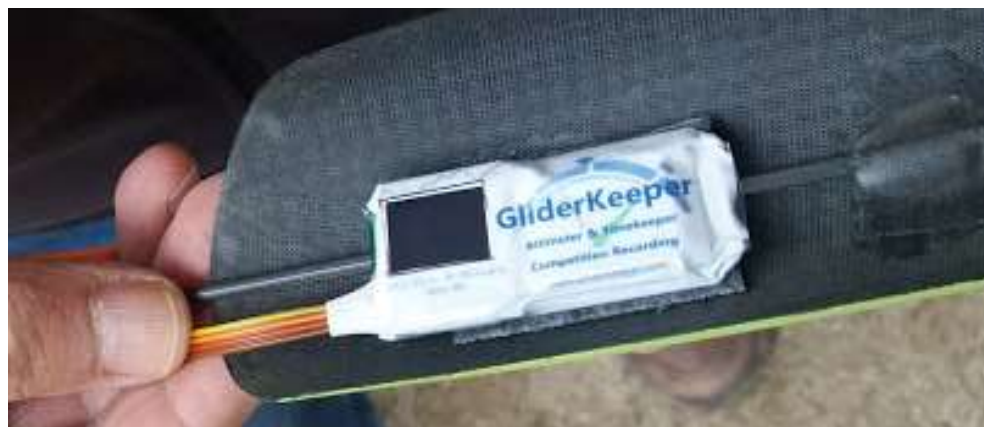
Figure 2: Installation au double face sur la verrière d'un modèle, Ultima.
