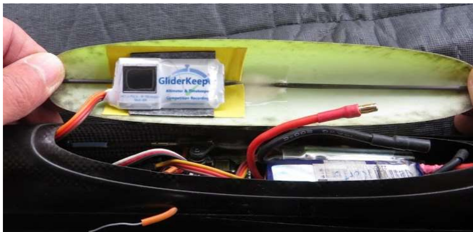
Figure 3: Installation dans un supra, notez le scotch de protection de la verrière
