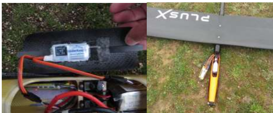
Figure 1: Installation dans un Supra et Installation par bande double face dans une PlusX
